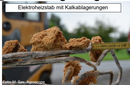
Aufgrund Überhitzung geborstener Elektroheizstab
